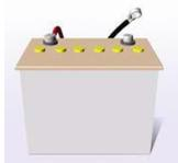
バッテリーからマイナスケーブルを外して所定時間放置
