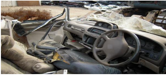
解体済車台でエアバッグ類未回収
