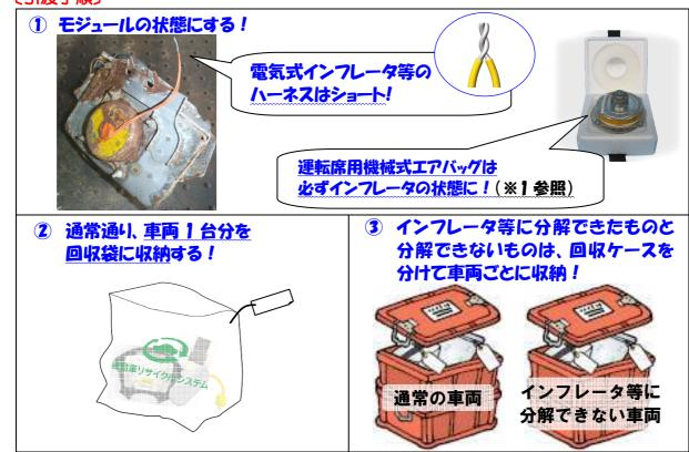
※1 **運転席用機械式エアバッグ**については運搬時の衝撃による誤作動を防止する目的から、ボルトの空転等によりナットが外せない場合でも、ドリルやホールカッター等を使用して 必ずインフレータの状態にし、専用回収容器に収納してください。
