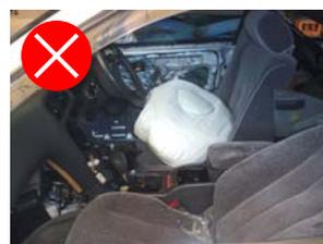
車台から外しシートの上等で車上作動処理する。
