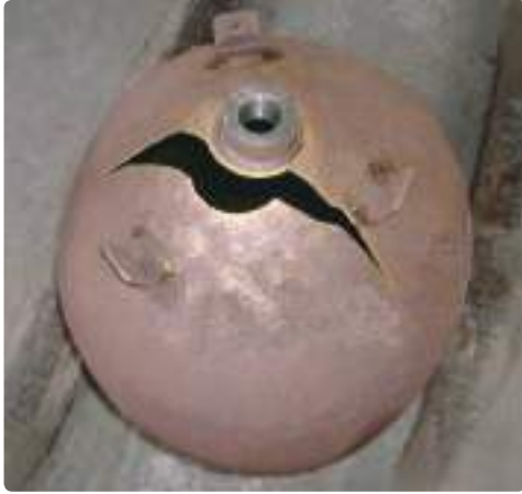
破壊試験により破裂した10kgボンベ(例)
