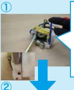
ドライバー等で窓中の小さい赤いレ バーを押す Press the small, red lever in the window with a screwdriver etc.
