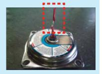
いない Harness is not twisted together Проводка разъединена شكل غير مناسب لحزام الأسلاك ہارنیس کی الگ الگ غیر جڑی ہوئی حالت
