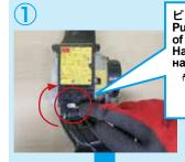
ピンを押しこみ矢印の方向に回転させる Push in the pin and turn it in the direction of the arrow Нажать на защёлку и повернуть в
