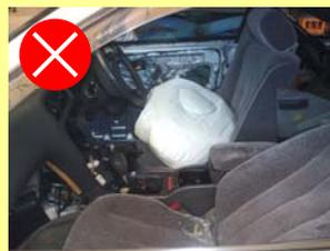
車台から外しシートの上等で車上作動処理する。
