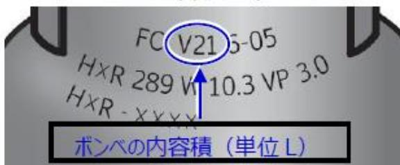
【例】ボンベ空重量が12kg、ボンベの刻印がV21の場合の満タン重量
