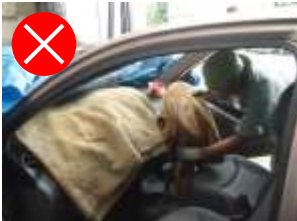
可燃性のカバーを直接掛ける。
